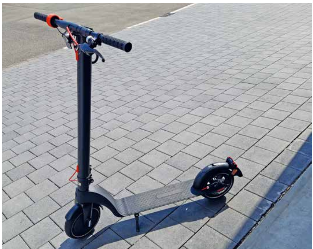
Der Roller verfügt über eine Hand- und Schutzblechbremse.
